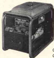
Motore "ASPERA" 4 tempi a benzina 1000 W a 220 Vac (50 Hz) e contemporaneamente 12 Vcc - 20 A o 24 Vcc - 10 A per carica batteria dimensioni 490 per 290 per 420 mm Kg. 28 viene fornito con garanzia e istruzioni per l'uso
